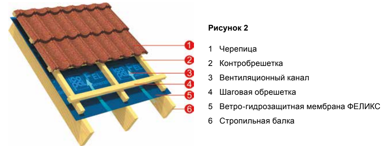
4.2 Утепленная крыша с диффузионной ветро-гидрозащитной мембраной (Рисунок 3).
