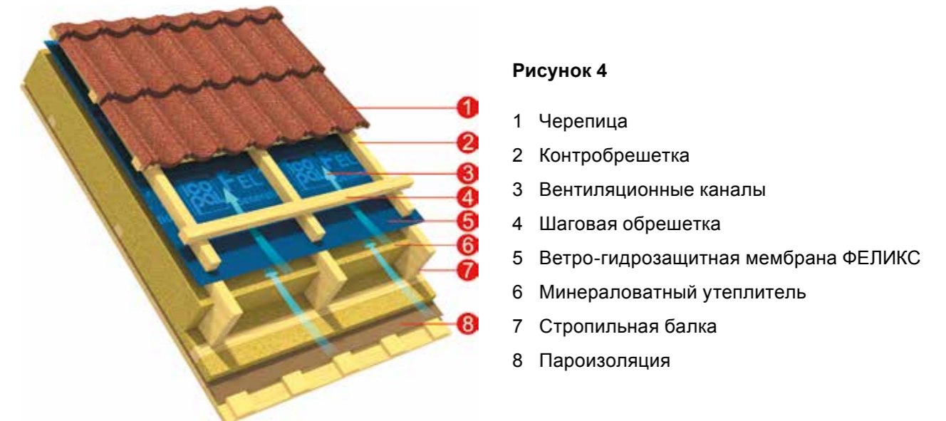
4.3 Утепленная крыша с паронепроницаемой ветро-гидрозащитной мембраной ФЕЛИКС (Рисунок 4).
