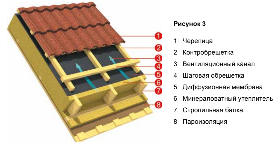
4.3 Утепленная крыша с паронепроницаемой ветро-гидрозащитной мембраной ФЕЛИКС (Рисунок 4).
