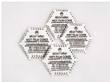
– Гребенка для измерения толщины мокрой пленки.
