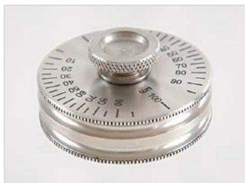
– Диск для измерения толщины мокрой пленки.
