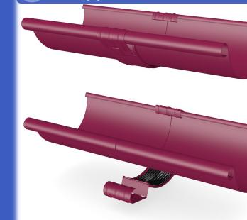
Соединитель желоба защепите за заднюю кромку желобов, оденьте хомут соединителя на переднюю кромку желобов, плотно прижмите соединитель к желобам и зафиксируйте хомут язычком.
