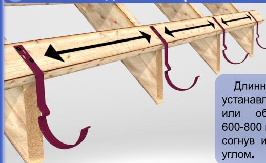
Длинные кронштейны устанавливают на стропила или обрешётку с шагом 600-800 мм, предварительно согнув их под необходимым углом.
