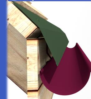
Карнизная планка или край кровли должны перекрывать желоб не более чем на 1/3 его ширины.
