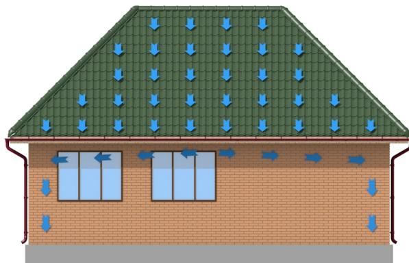
Крепление водосточного желоба необходимо осуществлять под уклоном в сторону водосточной трубы. Уклон желоба должен составлять порядка 1-2 миллиметра на 1 погонный метр желоба.
